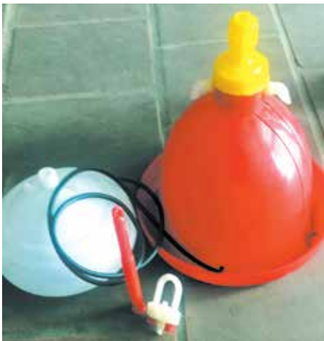
Hình 18. Các bộ phận chính của máng (trái) và máng uống tròn tự động hình chuông (phải)
